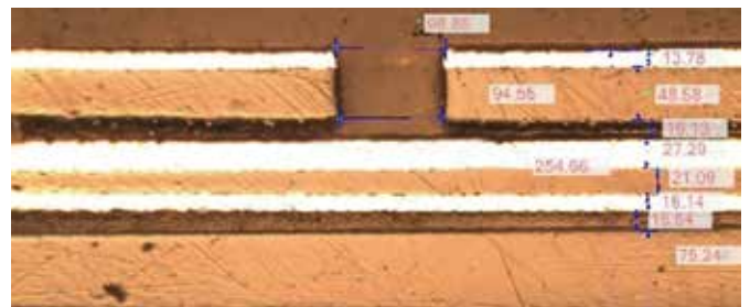
带胶多层软板上的高品质盲孔钻孔
