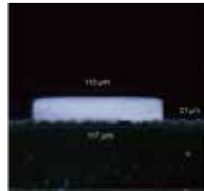
Orbotech Diamond 10W 白色防焊桥，最小底切
