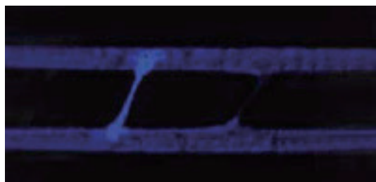
蓝光图像-清晰分辨出灰尘与细小短路 (灰尘亮度更高)
