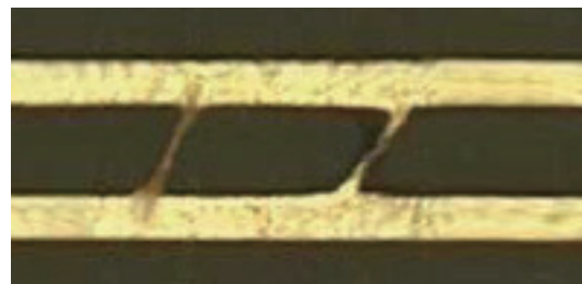
微观图像-灰尘与细小短路
