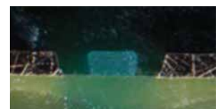
100μmソルダーダム、40μm厚ソルダーマスク
